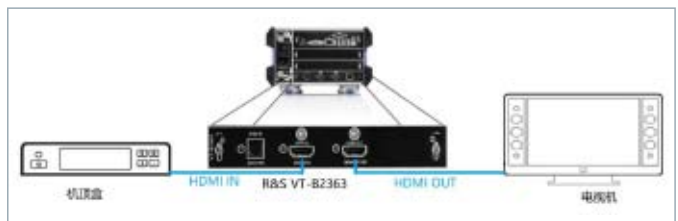
图2-2: R&S®VT-B2363模块支持HDMI的源端和接收端测试
