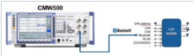
图65 车内Bluetooth无线连接测试框图
