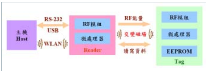
图20 RFID系统组成
