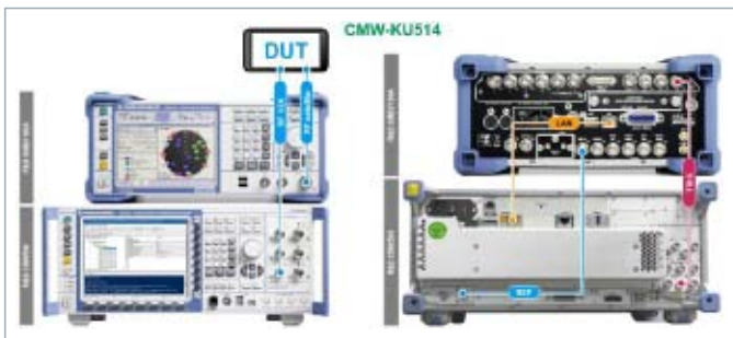
图51 C-V2X TM4通信接口测试方案
