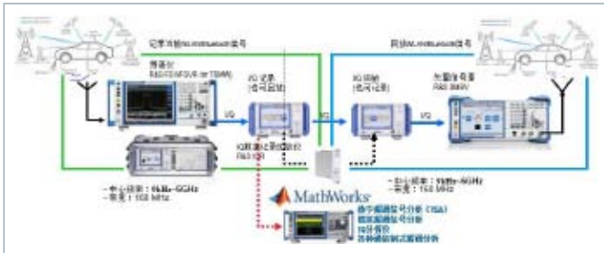
图71 车联网无线信号记录与回放测试框图
