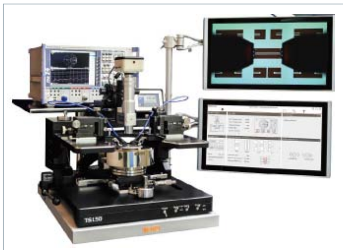
图1 典型的在片S参数测量系统
