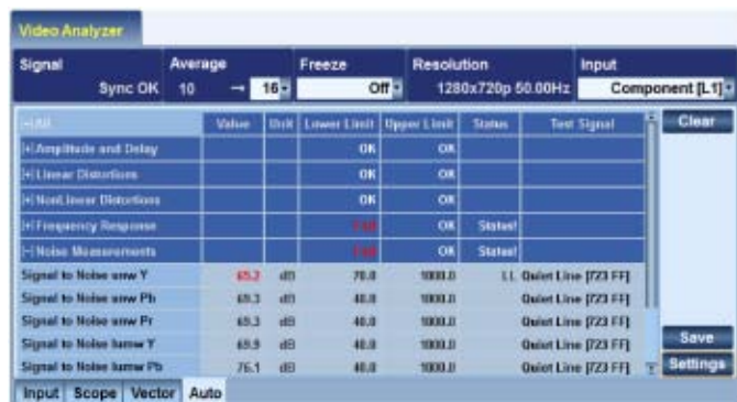
图3-3: 音视频信号的测量设置和测量结果
