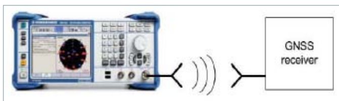
图11 导航接收机天线口辐射测试
