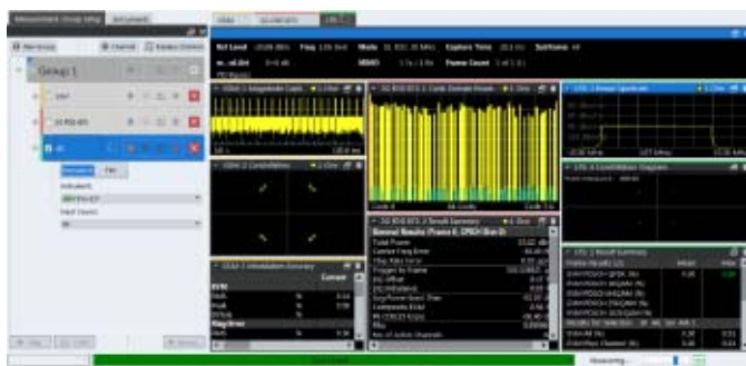
图45 FSW/FSV进行多任务测试
