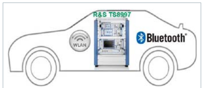
图68 车内WLAN级Bluetooth无线连接一致性认证测试
