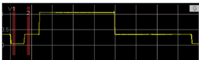
图3-6: RGB信号的同步脉冲测量
