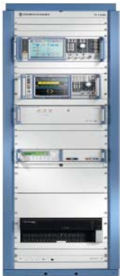
图39 DSRC/IEEE 802.11p一致性测试系统
