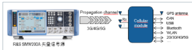
图46 蜂窝通信设备接收机测试框图
