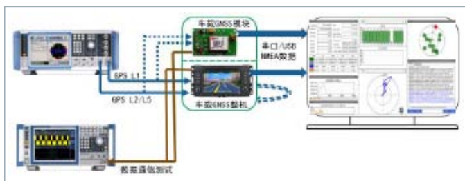
图58 DNSS/RTK接收机测试框图
