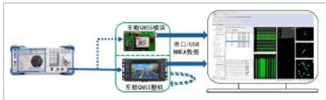
图55 车载导航接收机直连测试框图
