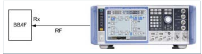
图3 SMW200A实现BBIC接收测试
