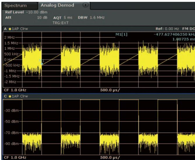
信号分析仪 (FSW) 本身具有强大的频道分析功能，还具有 MultiView 的功能，这意味着可以在单个测试任务中，通过多重窗口显示脉冲信号的频谱分析结果和脉冲参数测量结果。
