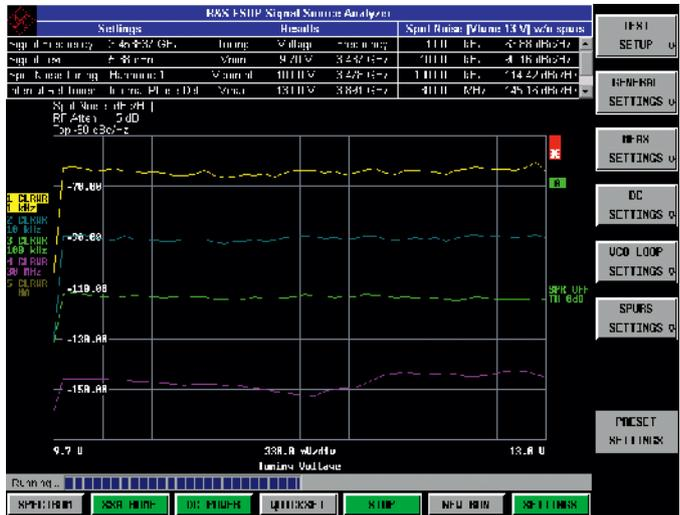
振荡器在不同频率下相位噪声值和调谐电压的关系
